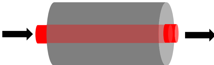
Fig. 10 – Esquema de la propagación de una onda ultrasónica a través del hormigón
