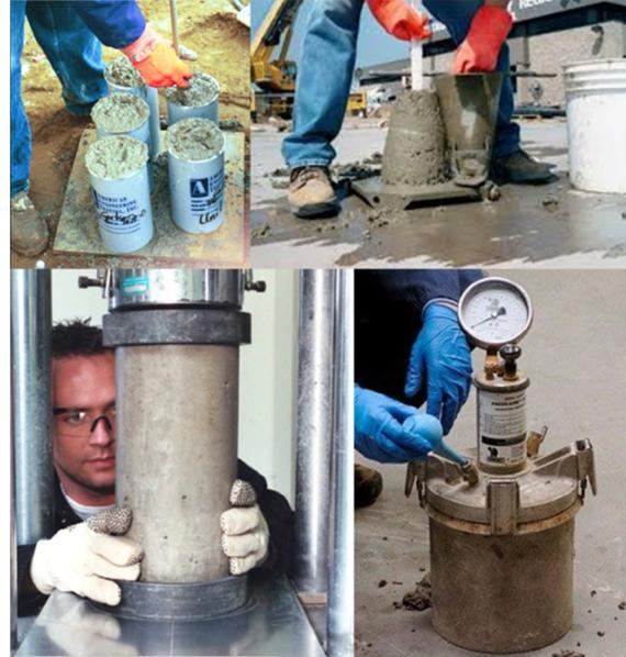
Este curso de actualización profesional tiene por objeto describir los controles y ensayos que es necesario implementar en la obra para verificar que las propiedades del hormigón en estado fresco y endurecido (trabajabilidad, resistencia y durabilidad) cumplen los criterios de conformidad requeridos por el CIRSOC 201-2005.
