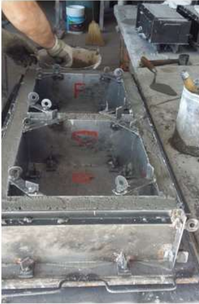
Figuras 4 y 5: Molde metálico y colocación del material en obra
