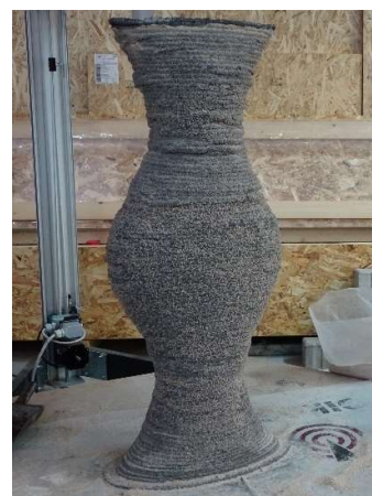
Figura 6: Izquierda: Resistencia mecánica de los morteros con los materiales seleccionados. Derecha: Objeto impreso con mortero de geopolímero GL.
