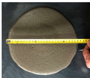
Figura 4: Imagen del ensayo de extendido del MAC
