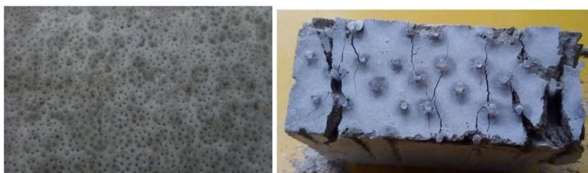
Figura 5: (a) Imagen de la superficie del MCT con D_{FOP} = 0,75 mm. (b) Imagen de falla en compresión de probeta de MCT con D_{FOP} = 1,5 mm
