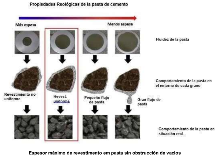
Figura 1: Representación de la pasta de cemento revistiendo la superficie del agregado.
