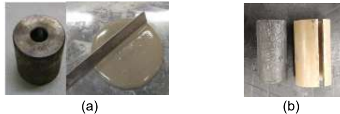
Figura 3: a) mini-cono de Kantro para evaluar la consistencia de la pasta de cemento y b) especímenes cilíndricos.
