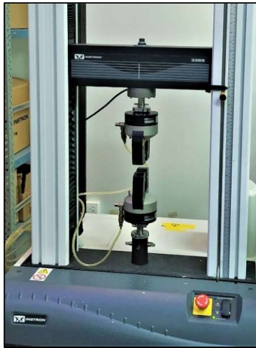
Figura 2: Ensayo a tracción con equipo Instron.
