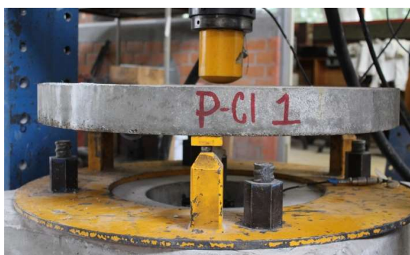
Figura 5: Ensayo de panel de sección circular, ASTM C1550.
