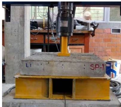
Figura 2: Ensayo de panel de sección cuadrada, EN 14488-5.
