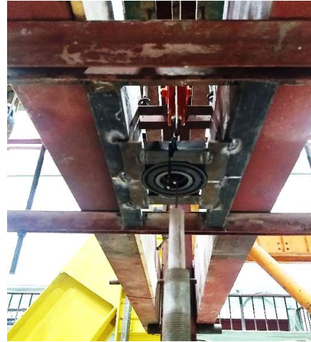
Figura 4. Sistema de sujeción del proyectil.
