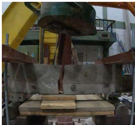
Figura 5: Viga sin refuerzo colapsada.
