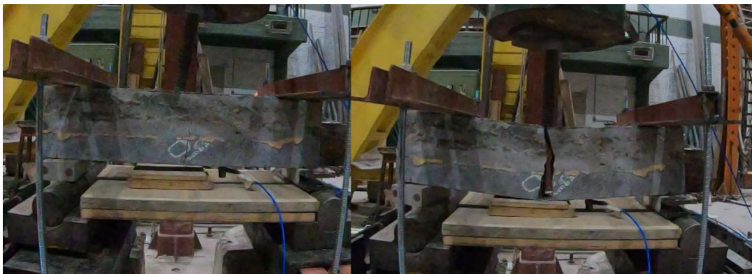
Figura 6: Viga con refuerzo de 60 \text{ kg/m}^3 en el primer y segundo impacto.
