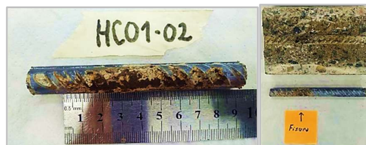
Figura 4: Deterioro en zona de fisuras en HC (izquierda) y en HRF (derecha).
