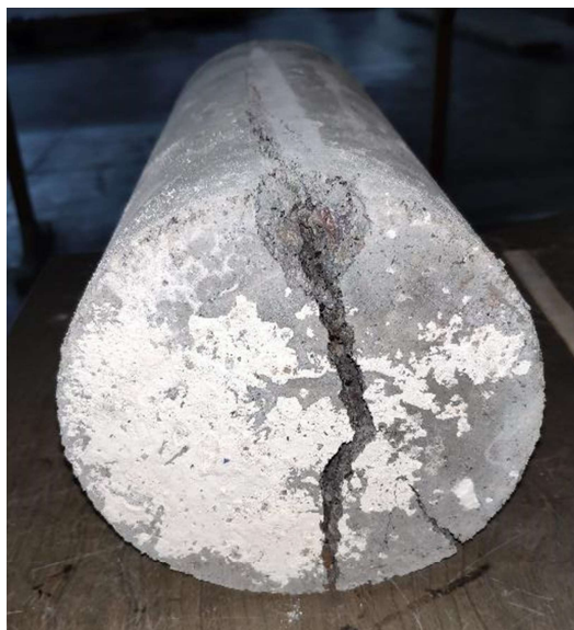
Figura 3: Falla de hormigón con F.R.N. en tracción indirecta.
