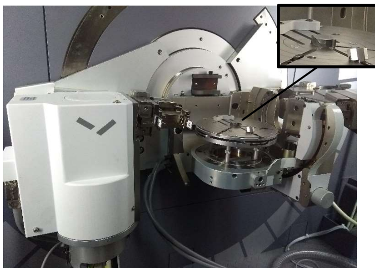
Figura 4: Cuna de Euler con la muestra de acero ADN 420 en posición para ser ensayada.
