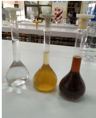
Figura 3: Solución de NaCl (3,5 %) sin extracto (izquierda), con extracto de yerba mate (centro) y con extracto de orégano (derecha).
