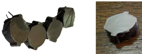
Figura 1: Muestras de acero antes (izquierda) y después (derecha) de ser pulidas.
