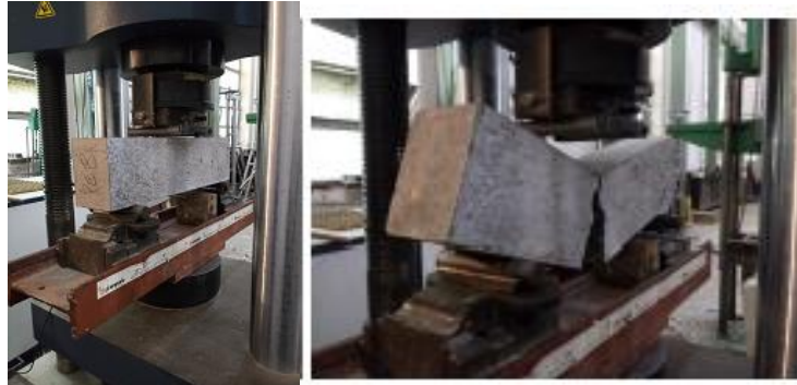
Figura 2: Ensayo de extensibilidad a carga rápida.
