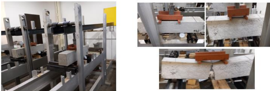
Figura 1: Ensayo de extensibilidad a carga lenta.
