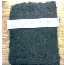
Figura 1: Fibrillas del recapado de neumáticos (FRN).
