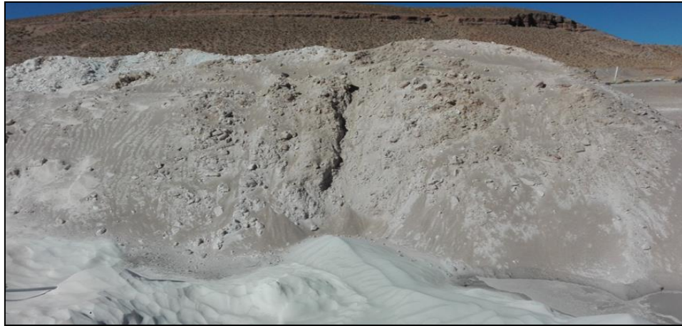
Figura 1: Desechos de finos de perlita acumulados al aire libre.
