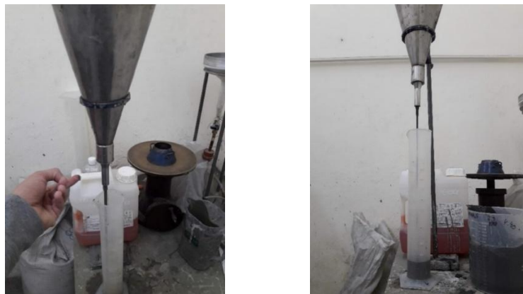
Figura 1: Determinación de fluidez mediante el cono de Marsh.
